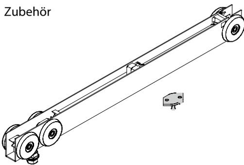
Fahreinheit mit Selbsteinzug, Dämpfung
