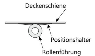
Auf Parallelität der Führungsschiene zur Laufschiene in horizontaler und vertikaler Richtung achten!
