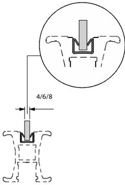
Dichtung- und Einfassprofil für Füllungen
