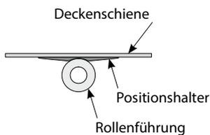
Positionshalter für Deckenschiene einklebbar 552 697
