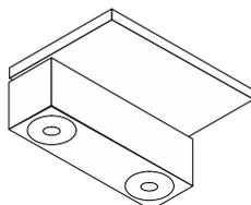
End-Mittelschlag mit Filz beklebt 928 365
